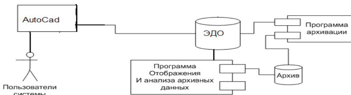
Рис.1. Модульная структура системы автоматизации работы в AutoCAD
